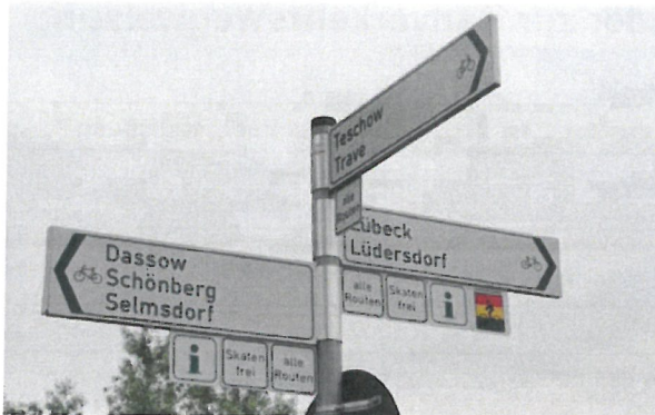
Abb. 12: Einschübe entgegen der FGSV; keine Entfernungsangaben, Gemeinde Selmsdorf (Landkreis Nordwestmecklenburg)
