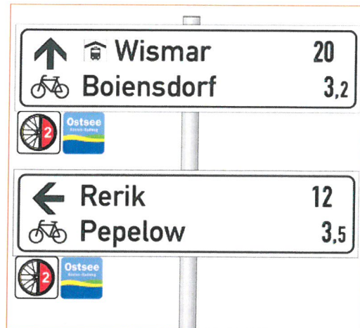
Abb. 2: Tabellenwegweiser mit Routenpiktogrammen
