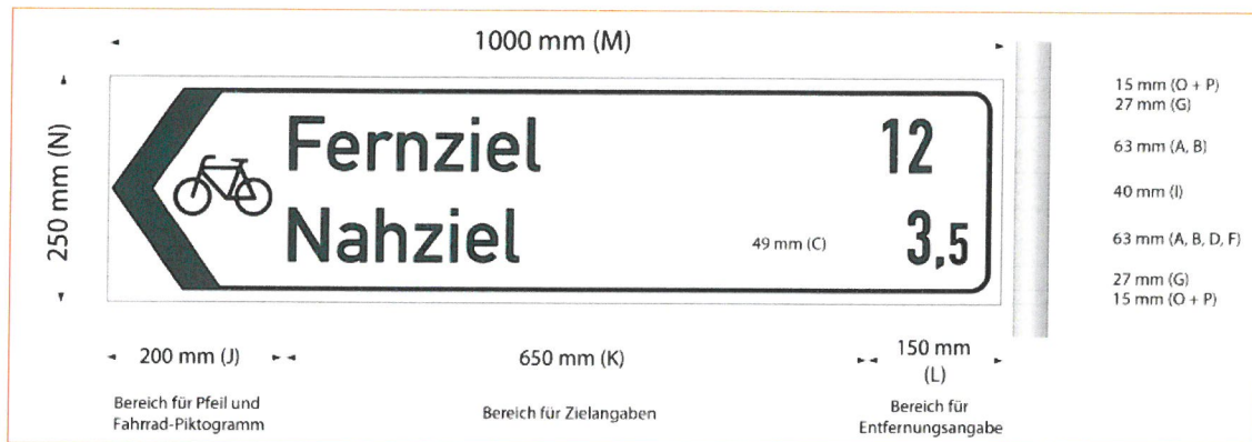
Abb. 10: Gestaltung und Bemaßung von Zielwegweisern (Beispiel)
